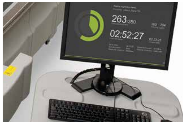
Konsola produkcyjna oprogramowania i-cut umożliwia dopasowanie rzeczywistych wymiarów i położenia obiektów do wydruku.
