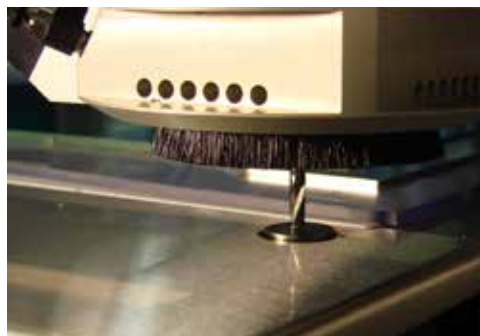
Automatyczny czujnik czubka noża regularnie sprawdza ostrza noży i końcówki frezerskie.
